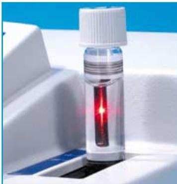
Detección rápida y completamente automática de cubetas gracias al escáner láser incorporado, para acelerar los análisis de rutina. La selección del método aplicado, la medición y el almacenamiento de los resultados se realizan de forma completamente automática sin pulsar ninguna tecla.
