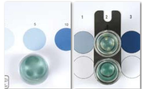
VISOCOLOR® alpha abarca tanto los análisis colorimétricos como los análisis titrimétricos. Generalmente se necesita un solo reactivo mezcla de varios componentes, para cada determinación, proporcionando un manejo más cómodo, rápido y seguro.
