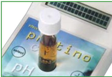
Al insertar la cubeta en el portacubetas, la medición fotométrica se realiza automáticamente, dispensando la inicialización desde el panel. El sistema óptico de última generación no necesita la protección del instrumento contra la luz del ambiente.
