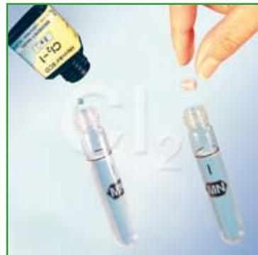
Sean reactivos DPD líquidos para cloro, cápsulas indicadoras NANOFIX para el valor pH o polvo reactivo para ácido cianúrico – todos los reactivos son fáciles de dosificar y se disuelven inmediatamente.
